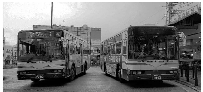
富田林駅前次々と発着する金剛自動車のバス（左2202号車：日産ディーゼル スペースランナー A PKG-AP35UK, 2010年式、右1903号車：三菱エアロスター PJ-MP35JK, 2007年式） 2台ともに三菱自動車バス製造（MBM）のボディを架装
