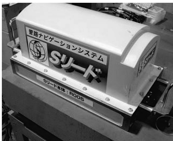
写真-1 管推進施工用掘削機位置推定装置「Sリード」
