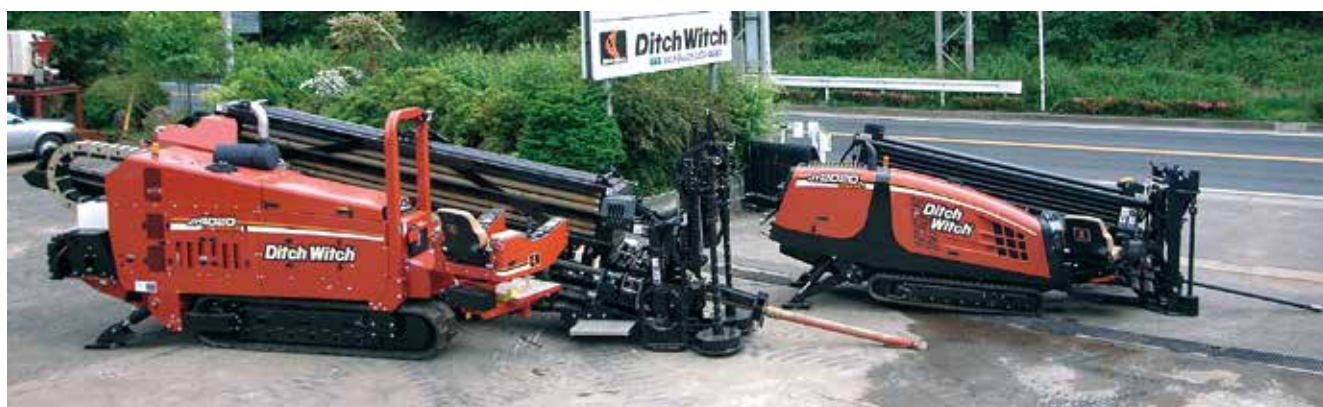
写真-1 ドリルユニット（地上設置型）
