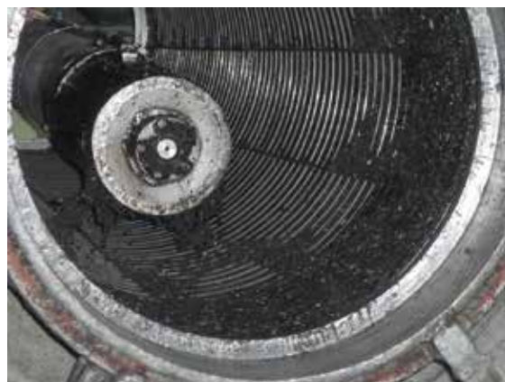
写真-1 レジンコンクリート管製造状況
