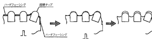
図-7 ボタン型ローラービットの摩耗の経過
