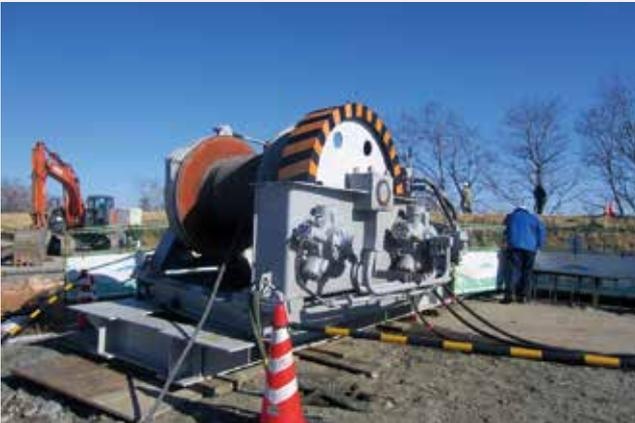
▲ ワイヤーによるポリエチレン管の引込装置
