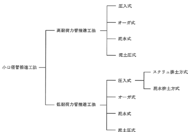
図-2 小口径管推進工法の分類
