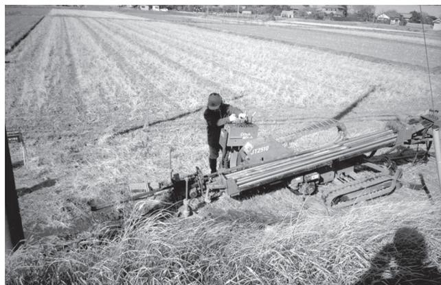
写真一5 引き込みを続ける水平ドリルマシン。
