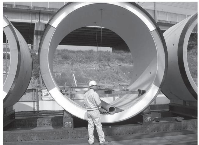
写真-3 呼び径3500超大口径管分割型PC推進管
